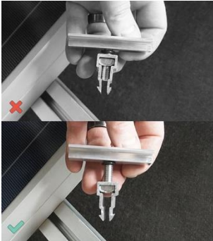
7A. Insexskruv på mittklämma får EJ vara för långt gängad genom clips.
