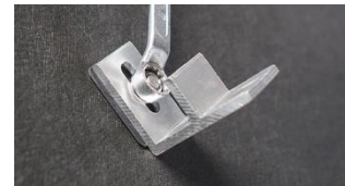
C. Drag åt med M10 sexkantsmutter 140643. Max åtdragningsmoment 10 Nm
