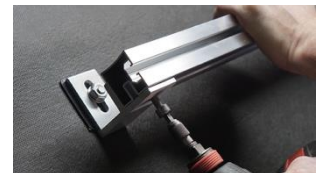
C. Drag åt skena med M8 insexskruv 140112. Åtdragningsmoment 8-10 Nm
