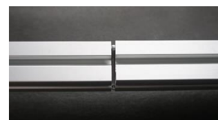
C. Profilförbindarens bula skapar en liten glipa.
