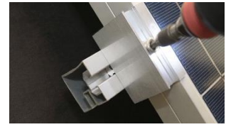
F. Skjut intill ändklämma mot solcellspanel och drag åt. Åtdragningsmoment 8-10 Nm
