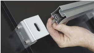
A. Tag fram skena 110111/110116 och för i sexkantskruv 140232.
