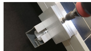
F. Skjut intill ändklämma mot solcellspanel och drag åt. Max åtdragningsmoment 17 Nm
