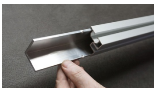
A. För i profilförbindare 130241 i skena.
