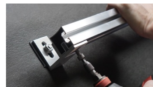
C. Drag åt skena med M8 insexskruv 140112. Max åtdragningsmoment 17 Nm
